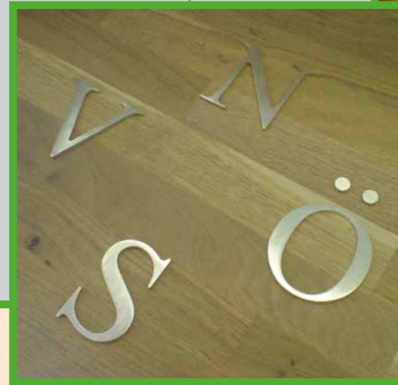
Utfrästa bokstäver i 2mm mässing till båt
